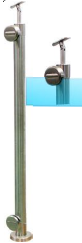
PP-2KLH redonda Verticais Poste pronto completo 2 fixadores para vidro corrido de 8 ou 10 mm,
