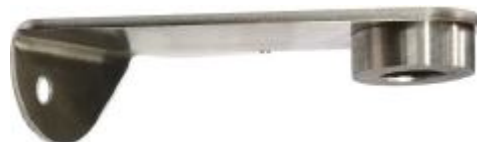
THA-1004 inclinado esquerdo , inox 316 , fixação no topo do tubo redondo 42,4 x 1,5 para fazer puxador de porta
