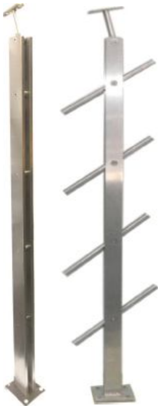
PPB2-poste de barra dupla 950 x 50x10 mm, fixação vertical, com 4 sth b-2, para 4 varões de Ø 12 mm com passagem entre as barras
