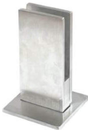
SPVR-60 série ligeira poste em inox 316L para fixar vidros até 60 cm de altura, espessura de 8 ou 10 mm, distância máxima entre peças de um metro, com fixação central, com bucha química rosca
