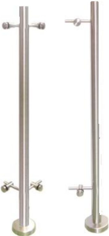
PP-2FH-1007 Poste pronto completo com 2 fixadores RON e ROS de 100 mm ,para vidro de 8 ou 10 mm em tubo de Ø 42,4
