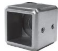
BDH-42,4 meia canafixador entre tubo e tubo de 42,4, para aparafusar e colar, inox AISI 316
