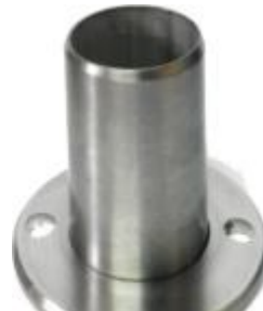
BDH-48,3 x 1,5 fixador interior com RON 80 x 5 em 304 para colar no interior do tubo 48,3 x 1,5
