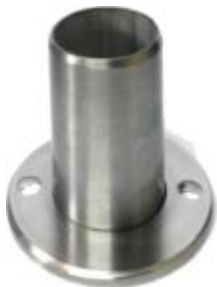
BDH-42,4 fixador interior com RON 70 x 5 em 316 para colar no interior do tubo 42,4 x 2 mm
