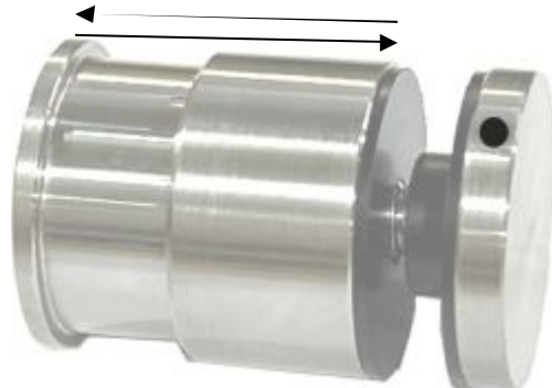
GLH-1014-40 Regulável de 25 a 40 mm inox AISI 316 furo mínimo no vidro 19 mm
