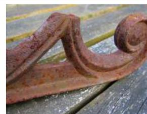
Mexa bem antes de usar. As superfícies enferrujadas devem estar livres de óleo e gordura. Remova a ferrugem solta. ROST-I-SOL®. Aplique em uma camada cinza sólida. Ao secar, a cor muda de cinza para azulado. Quando o processo for concluído, a superfície preta. Antes de pintar por cima (especialmente com tintas à base de solvente). Vernizes) Verifique a compatibilidade.
