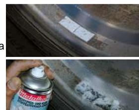
Agite bem a lata antes de usar e coloque-a no recipiente a ser limpo Pulverize a área dependendo do grau de contaminação Deixe agir por 5 a 15 minutos. Depois disso, as sobras podem removido com um pano ou espátula.
