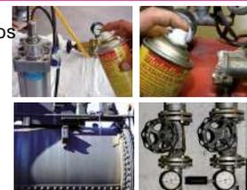
Para procurar vazamentos em sistemas de transporte de pressão. Sistemas de todos os tipos. Muito fáceis de usar, porque os vazamentos imediatamente através de espuma ou A formação de bolhas de ar é exibida. Pode ser usado, por ex. B. em conexões roscadas ou soldadas em recipientes e tubos, pneus de automóveis, castelos insufláveis ou outros itens de borracha infláveis
