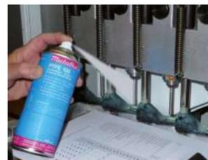
Pulverize sobre uma superfície limpa, seca e sem gordura. Se desejar uma espessura de camada maior, Deixe cada camada secar completamente e depois a próxima Aplicar camada.
