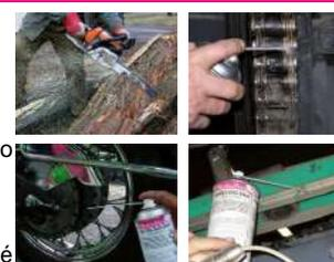
Lubrificação especial da corrente para condições extremas e altas forças de rotação, para correntes mais leves no toda a indústria, bem como para correntes de motocicletas muito utilizadas. A uma distância de aproximadamente 20 cm sobre o limpo, passe um Pulverize na corrente.
