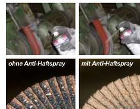
Spray para lixar e dar acabamento em superfícies feito de alumínio, cobre, aço inoxidável, aço com arruelas serrilhadas, Discos lamelares, discos de fibra, etc. Também para evitar queimaduras em aço e Aço inoxidável.
