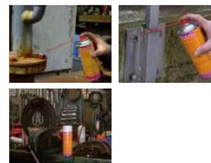
Soltar e soltar ferrugem e sujeira seguido de Proteção contra corrosão em conexões rosçadas, parafusos, válvulas, flanges de tubos etc. Pulverize na conexão enferrujada e deixe funcionar deixar
