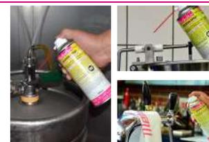
As peças a serem lubrificadas com 70-15 antes do uso Limpe com spray de limpeza rápido Metaflux e depois Pulverize finamente com spray de silicone. Pode ser usado em: metal, aço inoxidável, madeira, vidro, plástico, Borracha e papel, especialmente no setor alimentar.
