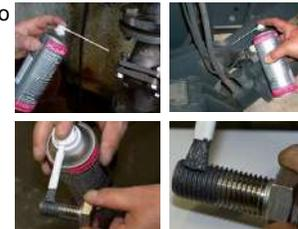
Evita gripagem, desgaste e corrosão
